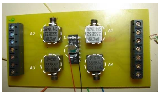
FIG. 3 : Emplacement des capteurs sur la carte électronique
